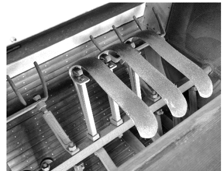
高林謙三が明治31年に発明した粗揉機(葉を揉む機械)の改良型。
